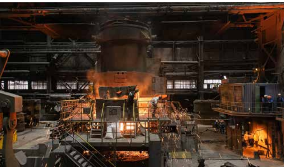
Az acélöntés a reaktortartály gyártási folyamatának tényleges kezdete
