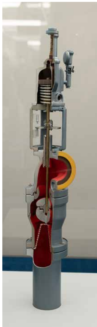
A turbina pillanatszerű leállítását biztosító gyorszáró szelep makettje
