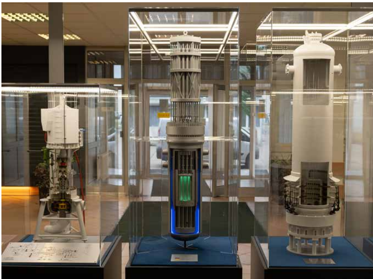
Primer köri főberendezések makettjei - balról jobbra: fő keringtetőszivattyú, reaktorberendezés, térfogat-kompenzátor
