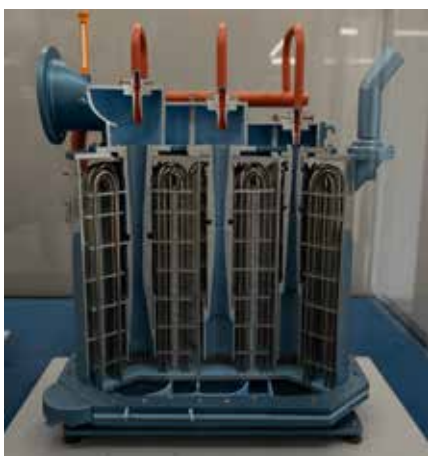
A turbinakondenzátorban vákuumot biztosító gőzsugárszivattyú makettje
