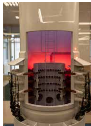
A primer körű térfogat-kompensátor víztete a fűtőtestekkel
