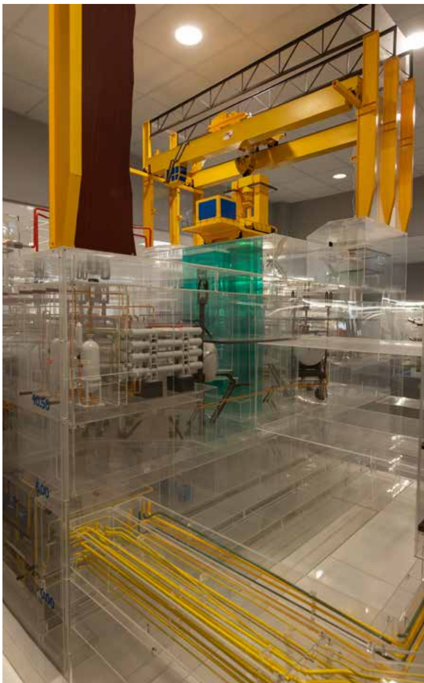
A primer köri technológia kialakítását és csőkapcsolását szemléltető primer köri makett
